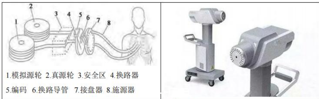
图9.1-1 后装治疗机工作原理及典型设备示例图
